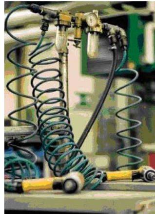
"Energievernichter" im Druckluftnetz
