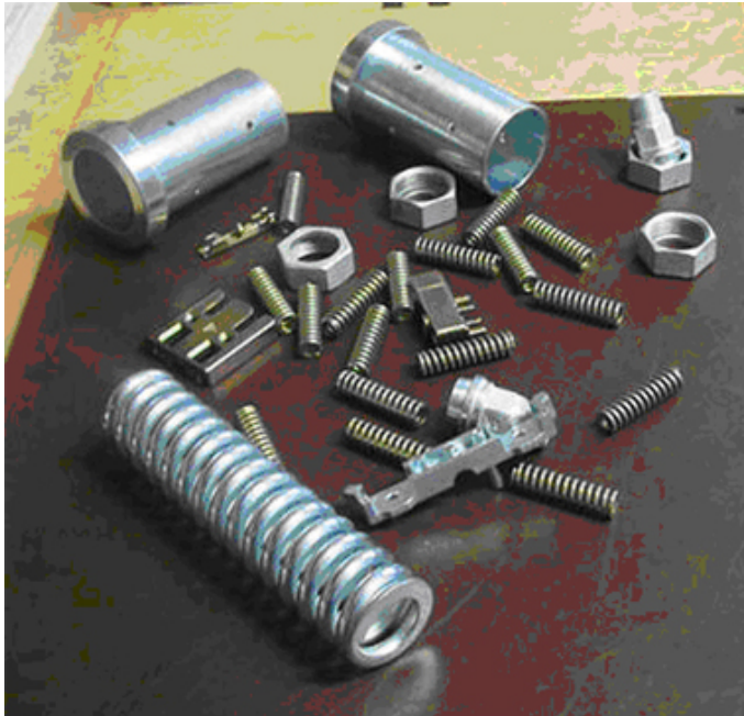
Bild: Verzinkte, teilweise chromatierte Teile
