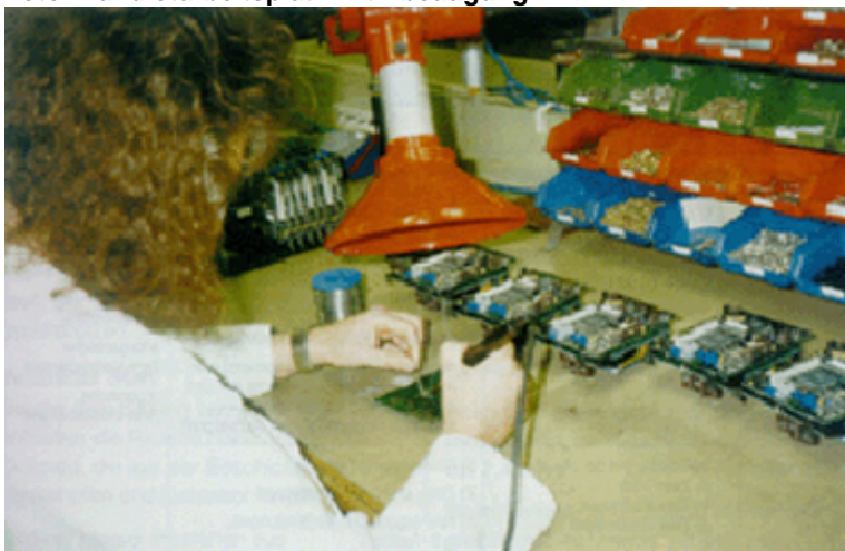
Foto: Handlöt Arbeitsplatz mit Absaugung
