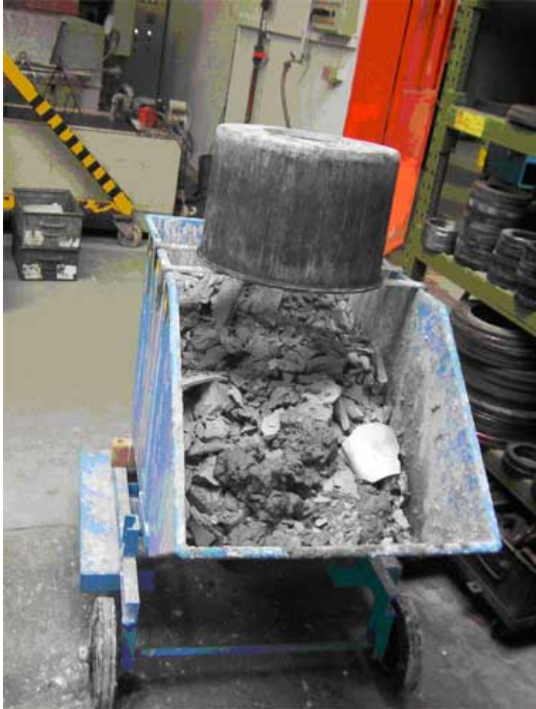
Bild: „Trockener“ Gleitschleifschlamm aus einer Zentrifuge
