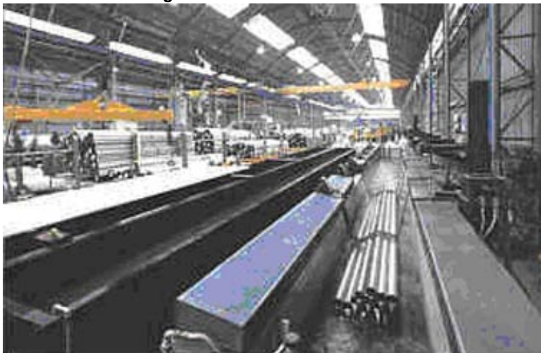
Bild: Beizbad für lange Rohre
